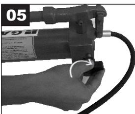
Feche a válvula, girando em sentido horário (esquerda para direita) e acione alavanca para comprimir a mola.
