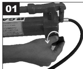
Abra a válvula da bomba hidráulica, girando no sentido anti-horário (direita para esquerda)
