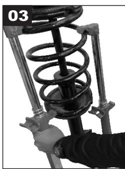
Posicionamento nas molas. Primeiro posicione as garras superiores, depois com as mãos empurre a garra inferior para posicionar na parte inferior da mola.
